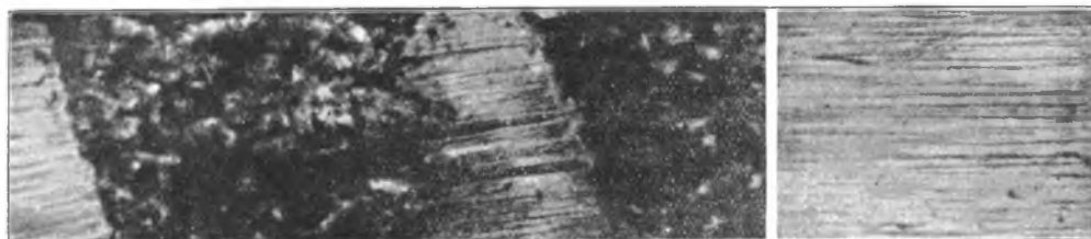
Links de aangevreten ruwe bovenleiding, waaraan men duidelijk de zgn. brandparels kerkent, zooals deze er uitziet bij gebruik van aluminium-sleepstukken. Rechts de bovenleiding bij toepassing van Fischer-stroomafnemers.
